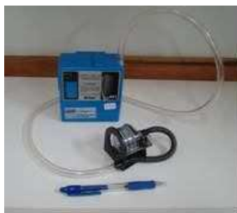
Figura 1. Bomba digital de amostragem de poeira com mangueira e suporte tipo cassete para filtro de membrana PVC
