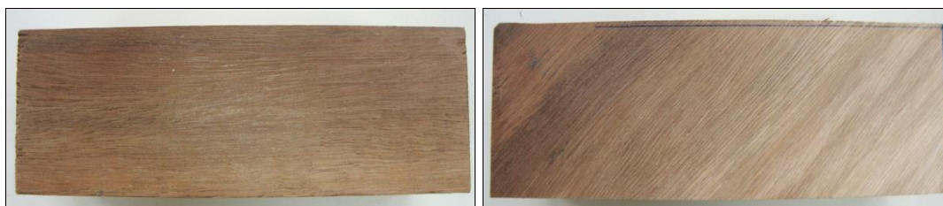
Figura 1 – Corpos de prova retirados com inclinação de 0° e 45° em relação aos eixos L,R e T.
