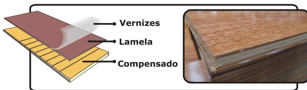
Figura 1 – Composição do piso engenheirado. Desenho e foto: os autores.
