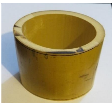
Figura 1 - Corpo de prova resistência a compressão/módulo de elasticidade
