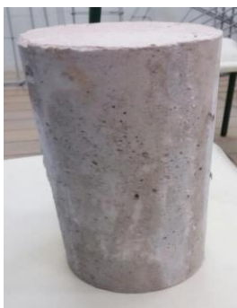
Figura 2: Amostra de concreto
