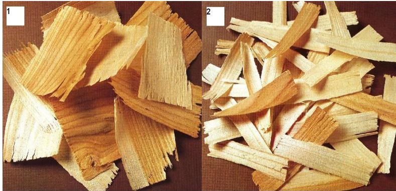
Figura 1 – Partículas utilizadas para produção de painéis estruturais. Onde: 1 - Partículas Wafer e 2 - Partículas Strand
