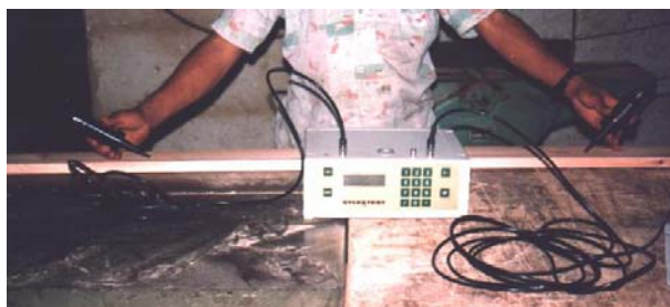
Figura 2 – Aparelho SYLVA TEST® e ensaio de ultra-som
